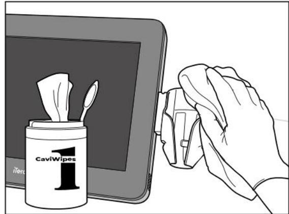
Abbildung 208: Reinigen der iTero Element 2 Plus Halterung für die mobile Konfiguration
